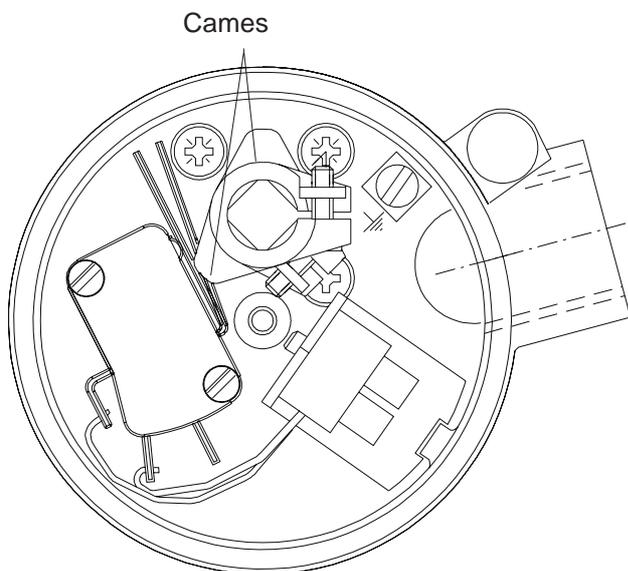
Les 2 cames peuvent être ajustées à la course de l'actionneur : utiliser un tournevis pour vis M3.
