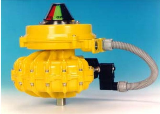
Le nouveau boîtier de fins de course Kinetrol présente 2 orifices taraudés pour les câblages propres aux fins de course et au pilotage des électro-distributeurs. Cette évolution permet de conserver les qualités originelles des boîtiers KINETROL, comme l'étanchéité IP65 et la robustesse d'un boîtier moulé en zinc revêtu d'époxy, le réglage facile, rapide et précis des fins de course, le montage direct et compact sur les actionneurs KINETROL.
