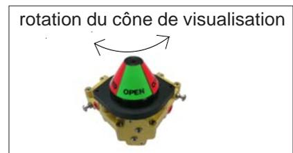
5 - Placer le joint torique d'étanchéité dans la gorge du capot de protection puis visser ce dernier sur l'embase (vis fournies).
