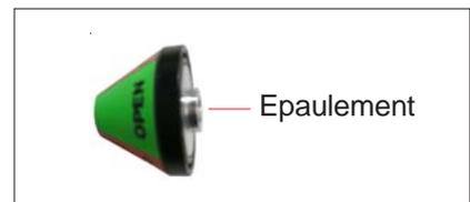
4 - Poser le groupe "insert + cône de visualisation" sur l'axe de l'actionneur puis faire tourner le cône de visualisation (il glisse autour de son insert) pour que l'une des 2 plages vertes soit positionnée comme sur la photo (position ouverte)
