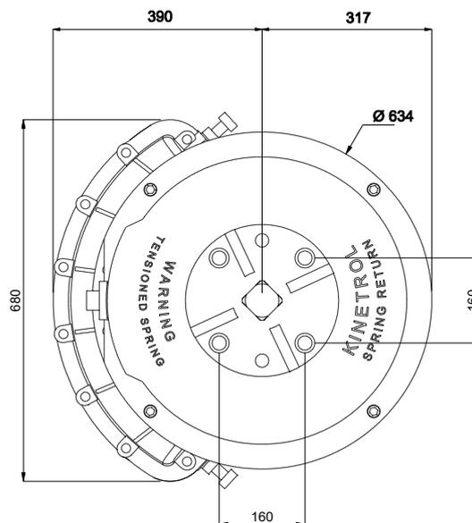
Ressort monté entre l'actionneur et l'élément à motoriser
