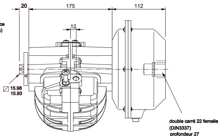
Ressort monté entre l'actionneur et l'élément à motoriser
