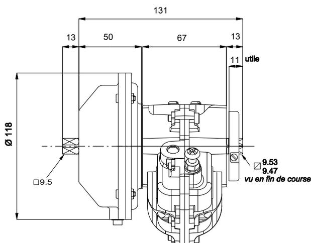
Ressort monté entre l'actionneur et l'élément à motoriser
